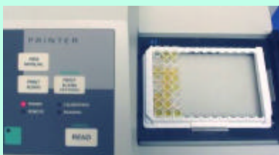
y leer el ELISA en un espectrofotómetro dentro de los 30 minutos contando a partir del momento en que se agrega la solución STOP
